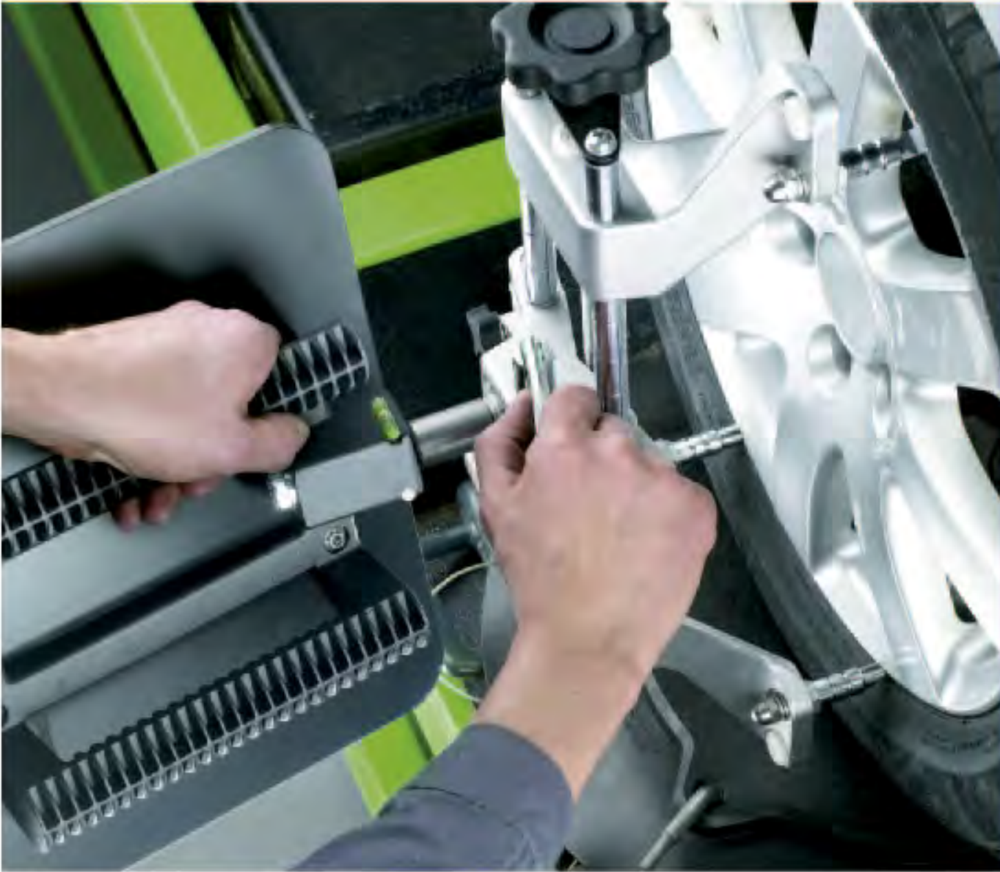
Montaje sencillo: Sólo es necesario posicionar una vez las placas
